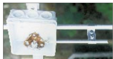
Bild 12: Praktische Ausführung der Gamma-Anpassung. Auf guten Massekontakt zwischen Buchse und Trägerrohr ist zu achten! Fotos: Autor
