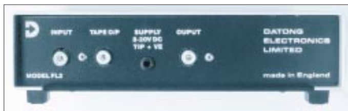
Bild 3: Rückseite des Gerätes. V.l.n.r. Cinch-Buchse für Eingang, Cinch-Buchse für Tape-Ausgang (680 Ω), Betriebsspannungsbuchse, Cinch-Buchse für Ausgang (4 bis 8 Ω)
